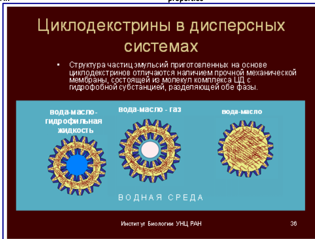
Рисунок 5. Примеры образования клатратов ЦД с различными по физико-химическим свойствам веществами
